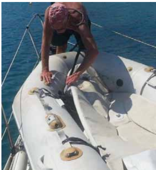
Tillverkning av provisorisk botten
